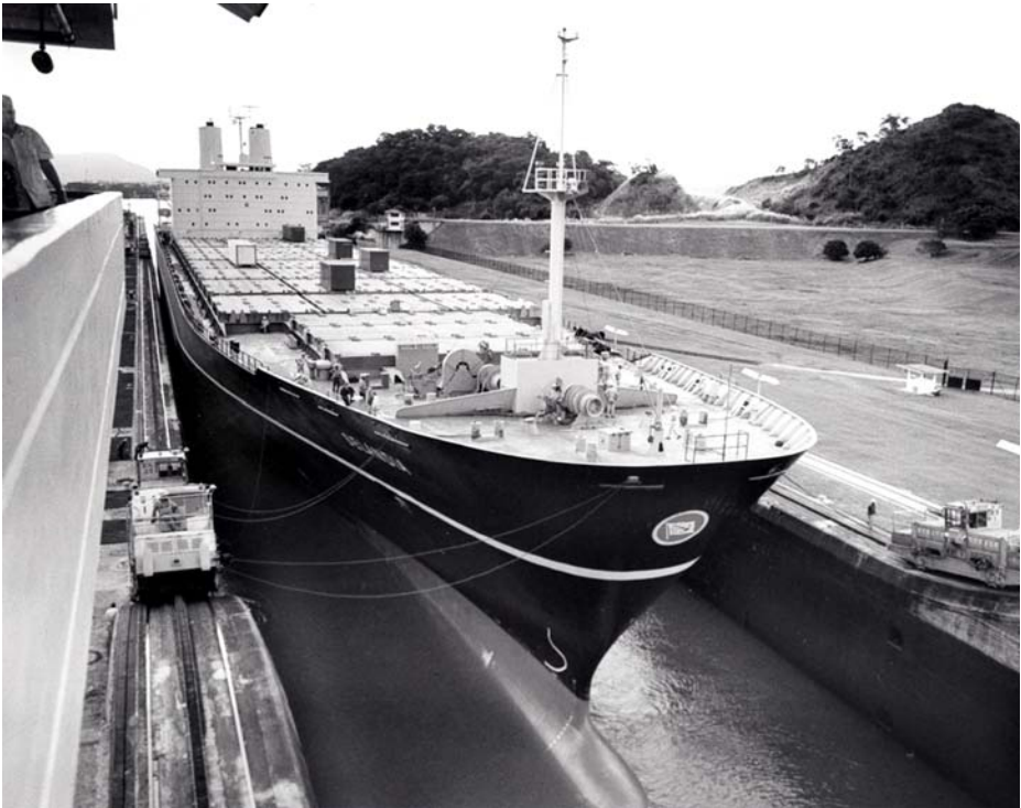
SELANDIA trækkes gennem Panama-kanalen af to lokomotiver. Skibet er i ballast, og billedet stammer formentlig fra den første jordomrejse i 1972. Bemærk hvordan skibets bredde passer nøjagtigt til kanalen.
